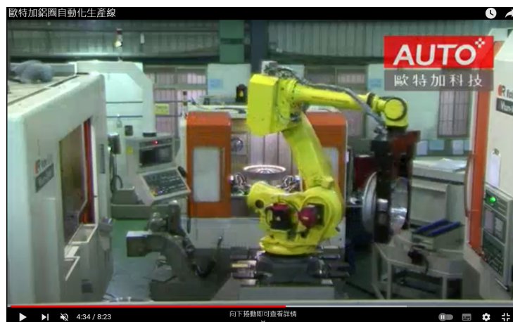
圖 9 Youtube 機械手臂應用影片：輪圈自動化產線
