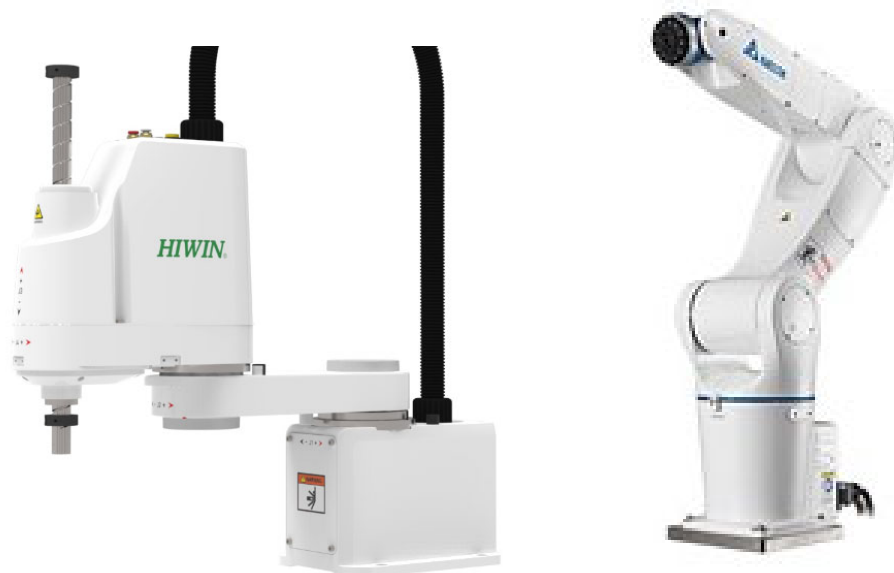
圖 4 系上可供教學使用之機械手臂。(a)SCARA 四軸機械手臂、(b)垂直式六軸機械手臂。
