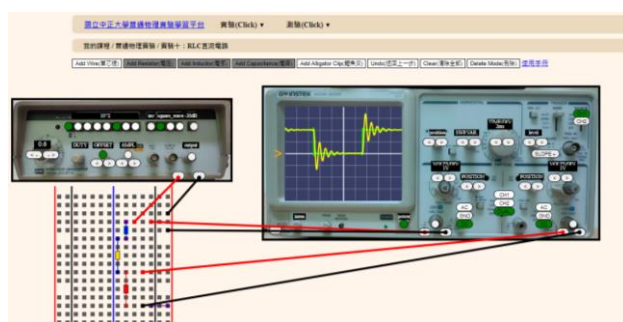
圖 5B：RLC 直流實驗之 PhET 模擬程式
